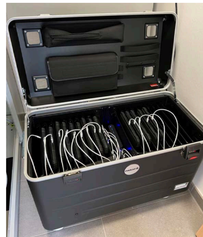
Zur Ausstattung gehören 25 Tablets. Der Tablet-Koffer dient zum Laden und Zurücksetzen der Geräte.
